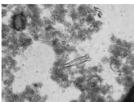
写真2 輪虫類 philodina 属の顕微鏡写真(×60倍) 本属が優占化しているときの処理水は、BOD10mg/l以下であることが多く、透視度も100cm以上を示す。また、本属が多量に出現すると汚泥発生量も少なくなる。
