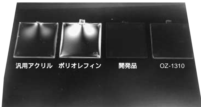
図6 射出成形品の偏光板間に配置した写真 成形板は直交ニコル状態に配置した2枚の偏光板の間にはさんである。
