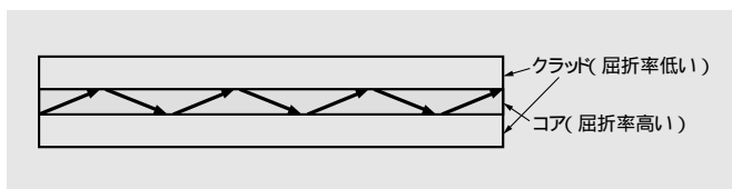
図2 光導波路が光を導く原理 ある特定の角度より浅い角度で光導波路に入射された光は、コアとクラッドの境界面で全反射を繰り返し、コアに閉じ込めながら伝搬する。
